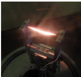
Рис. 10 Вид датчика с отдельными струнами. На измерительную струну подается постоянный ток 1.3 А, имитирующий высаживание на струну тепловой мощности около 6000 мВт.
