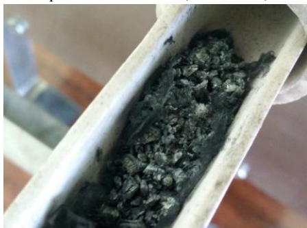
Рис. 14 Результат восстановления сульфида молибдена \text{MoS}_3 до оксида молибдена \text{MoO}_3 .
