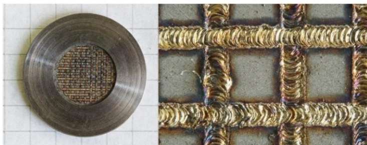
Рис. 6 Мишенный диск с запрессованным молибденом после лазерной обработки (слева), с 40-кратным увеличением (справа).
