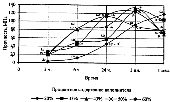
Рис. 3 Зависимость прочности на изгиб склеенных базальтовых образцов от времени (фракция 0...0,056 мм).
