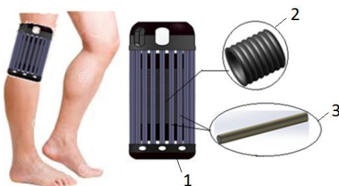
Рис. 5. Применение ортеза: 1 - ортез, 2 - упругий сустав, 3 - актуатор
