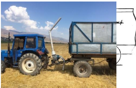
Նկ.1. Մղեղի հավաքման պնևմատի խակրիչի տեխնոլոգիական սխեման և փորձնական նմուշի լուսանկարը: 1-օդամղիչ, 2-մղող օդատար, 3-ներծծող ճկափող, 4-Էլեկտրաշարժաբեր, 5-շուռուղիկաշարժաթևային մեխանիզմ, 6-ծայրափողակ, 7-կարգավորիչ պտուտակ, 8- ուղղորդիչ, 9-կարդանային լիսեն:
