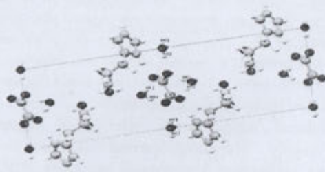
Рис.9. Расположение молекул в структуре \gamma -фазы 2L\text{-His.H}_2\text{C}_2\text{O}_4.3\text{H}_2\text{O} .
