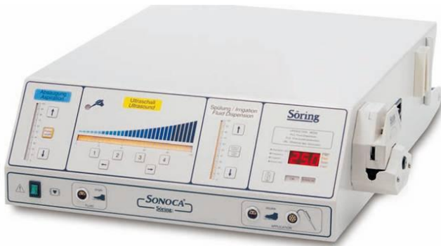
Նկար 1. Ցածր հաճախականության ունիվերսալ ուլտրաձայնային գեներատոր «SONOCA 300» («Soring» ընկերություն, Գերմանիա)
